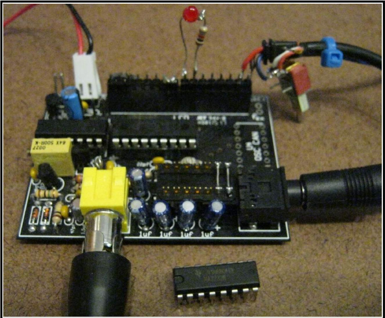
FOR A SERIAL BACKPACK LCD, THE MAX232 CHIP IS NOT NEEDED AS 5 VOLT LOGIC SIGNALS ARE ALL THAT IS REQUIRED BY THE MICRO CONTAINED WITHIN THE BACKPACK DEVICE.
